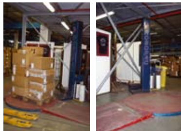
Aparatul pentru împachetarea automată în folie contractilă
